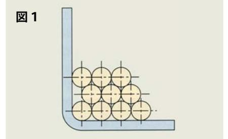
図 1 は従来のワイヤロープのドラムへの巻かれ方です。2 層目からはワイヤロープ同士が接触してできた溝の上に次のワイヤロープがはまりこむという考え方です。
