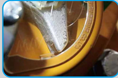
重度に摩耗したストッパー
